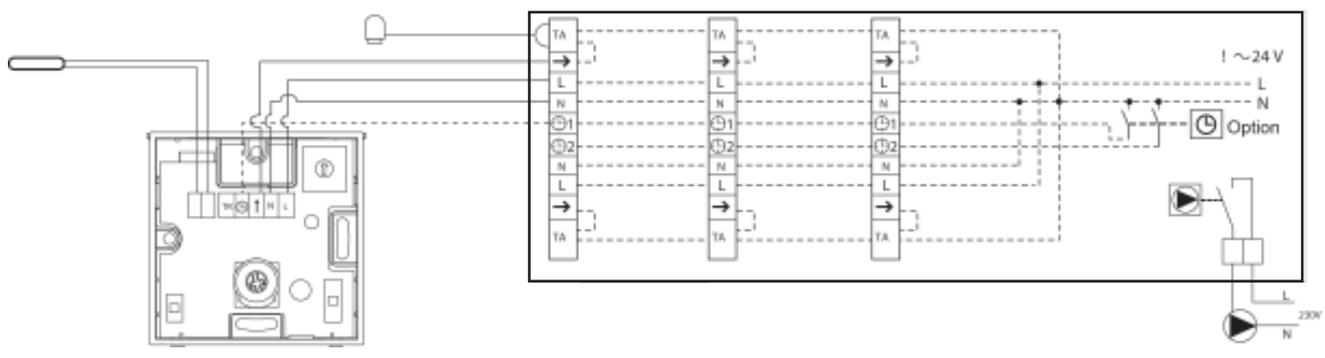
Tilkobling av flere reguleringsmotorer på en romtermostat (max. 5 reguleringsmotorer på en romtermostat).
